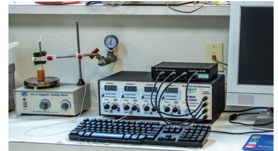
データ収集システムを備えた WPI フリーラジカルアナライザーの典型的な実験室のセットアップ
