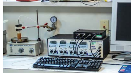
データ取得システムを備えた WPI フリーラジカルアナライザーの典型的なラボ設定
