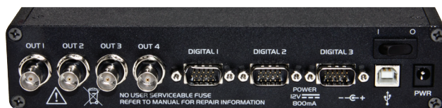
Lab-Trax-8/16の背面パネルには、4個のアナログ出力と、デジタル入力または出力、USBポート、電源ソケット、電源スイッチがあります
